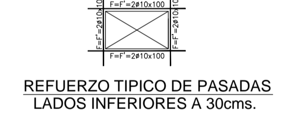
REFUERZO TIPICO DE PASADAS LADOS INFERIORES A 30cms.
